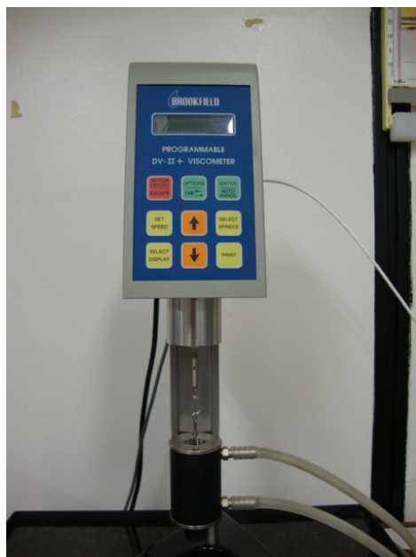
Figura 1.5: Viscosímetro Brookfield de cilindros concêntricos utilizado nos experimentos. (Laboratório do Vortex - ENM - UnB)
